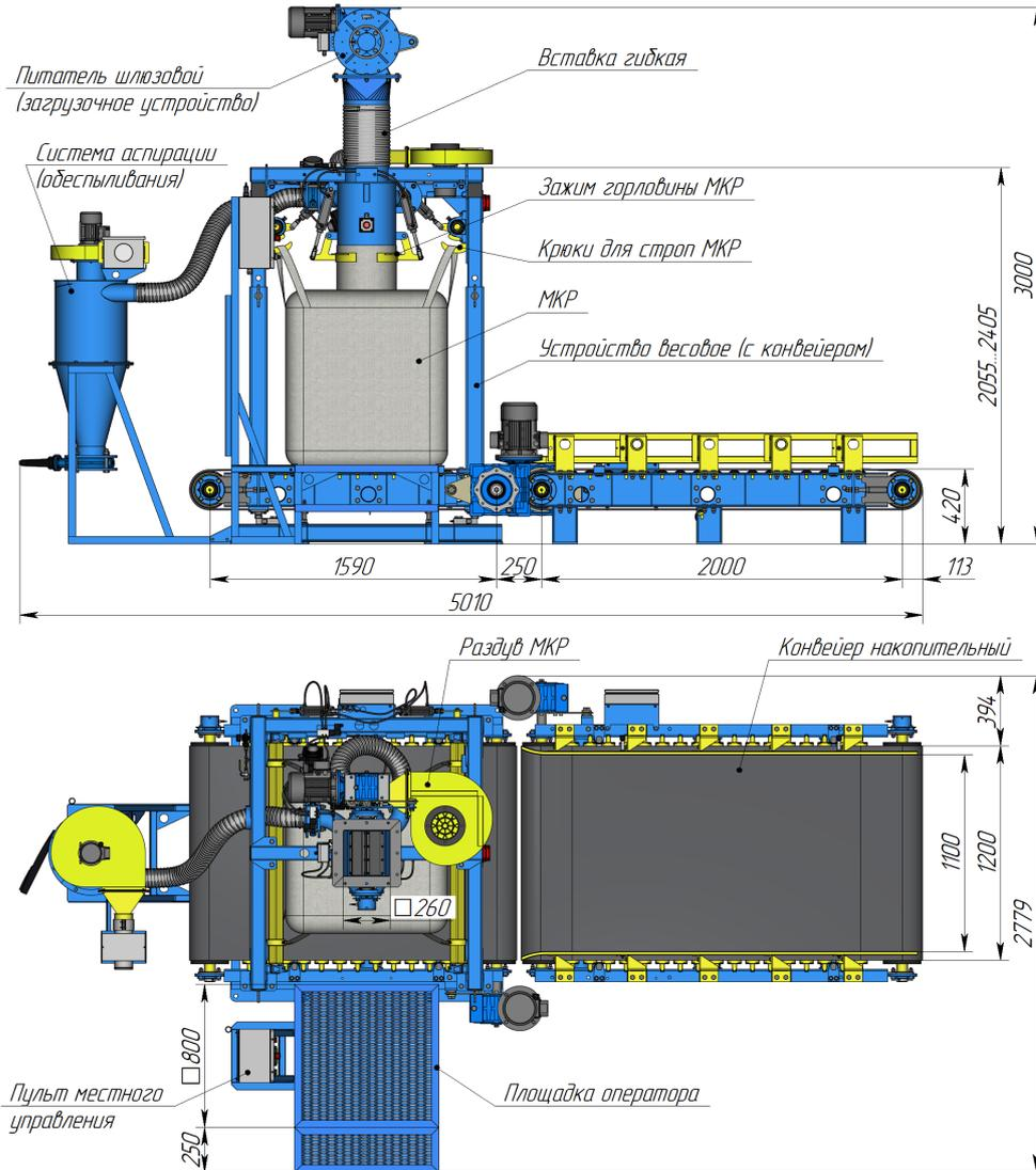
Загрузочное устройство (конвейер ленточный, винтовой, питатель шлюзовой)
