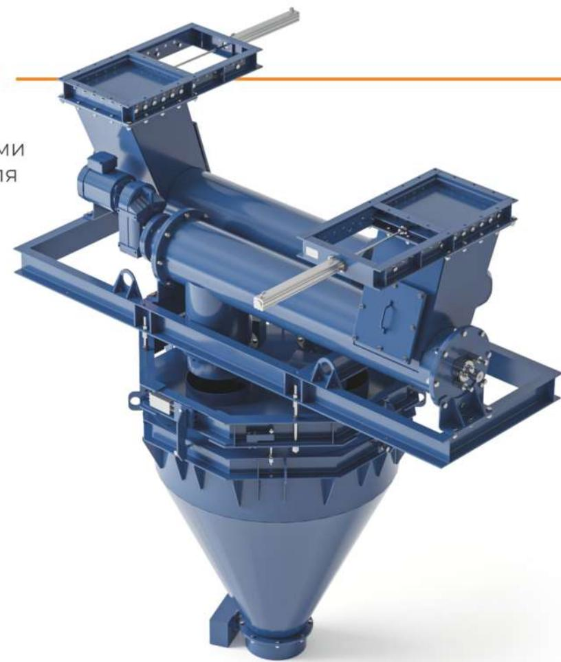
По команде оператора открываются затворы на каждой дозирующей линии (возможно исполнение с одной и двумя линиями) и начинает работу винтовой питатель. По мере приближения к заданному весу порции, винтовой питатель снижает обороты для точного дозирования. После успешного набора дозы затворы закрываются и отключается винтовой питатель. После паузы набранная порция отгружается через нижний затвор в технологический процесс.
