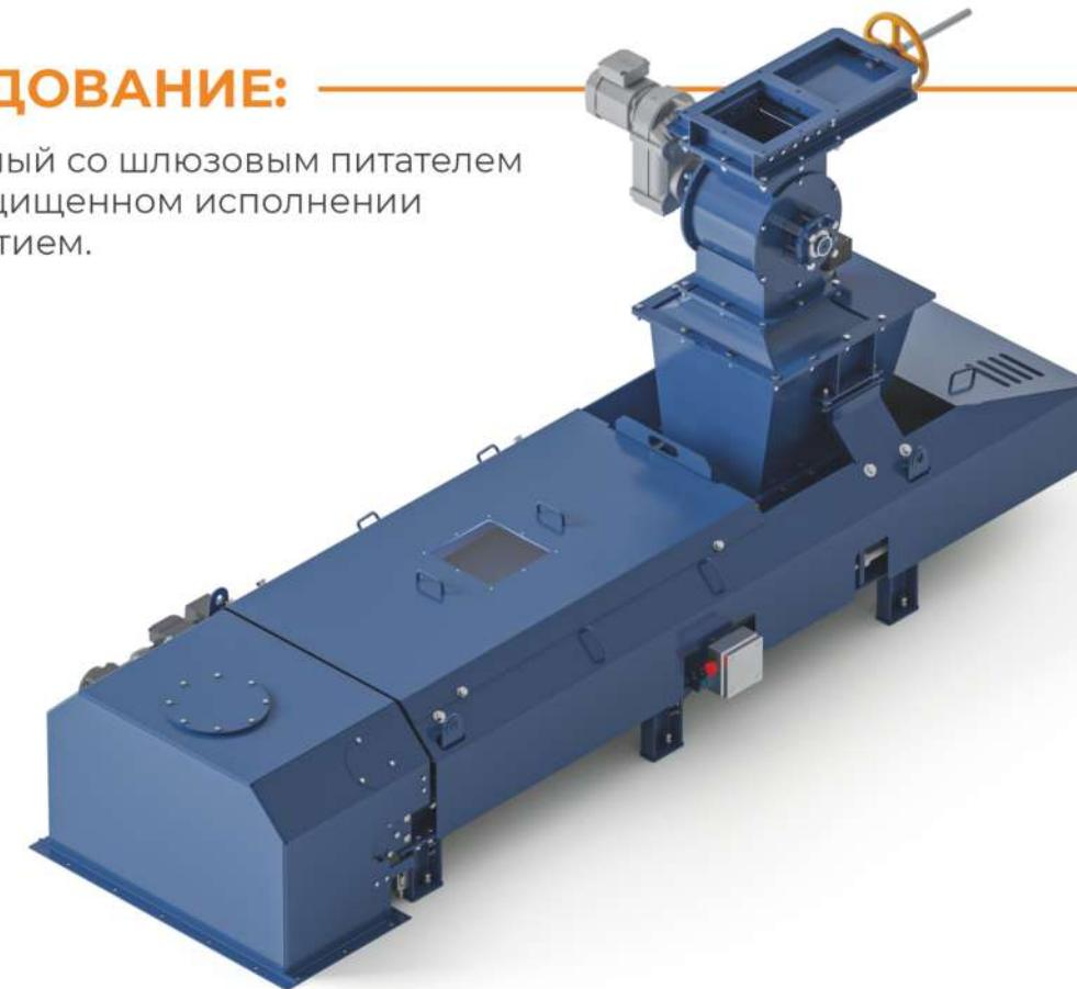
Дозатор предназначен для обеспечения технологического процесса непрерывной подачей реагента. Особенностью данного изделия является алгоритм согласования производительности шлюзового питателя и ленточного дозатора. Синхронность работы приводов позволяет выдавать производительность с повышенной точностью.
