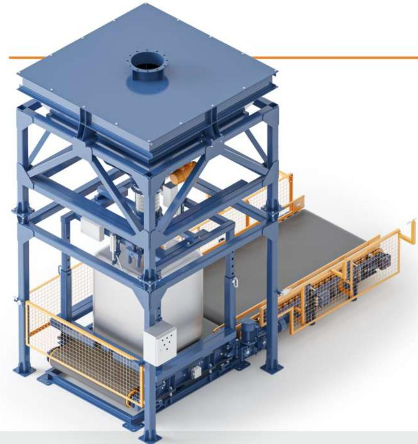
Станция затаривания была разработана для крупнейшего в России производителя высококачественных сплавов на основе цинка. Станция затаривания предназначена для фасовки смеси солей в мягкие контейнеры типа "Биг-Бэг", дозами массой от 500 до 1500 кг и перемещения на накопительный конвейер.
