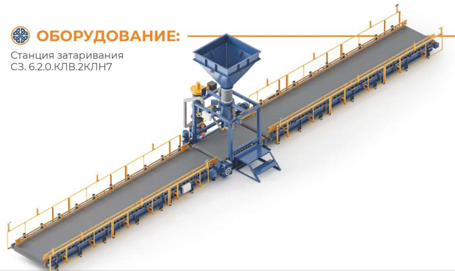
Станция затаривания С3.6.2.0.КЛВ.2КЛН7 предназначена для фасовки сыпучих материалов, включая цемент, песок, гипс, известь, тальк и других, в мягкие контейнеры типа «Биг-Бэг», дозами массой от 500 до 2000 кг.
